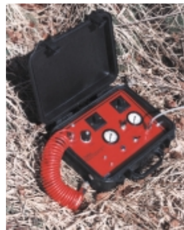
Sistema Portátil con Bomba Modelo 407 (ó 408), con Controlador Neumático Modelo 465 (abajo).
